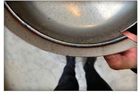
Kuva 5. Päädyn ja rungon välinen hitsattu liitos sisäpuolelta.
